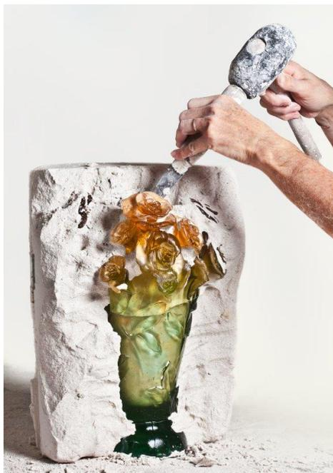
Figure 19 : Photographie illustrant la sortie d'une œuvre en verre d'un moule en plâtre réfractaire
